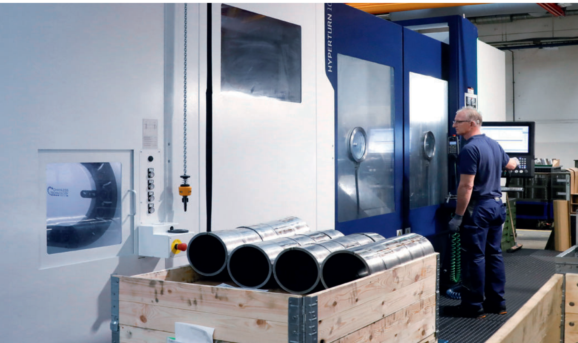
Dreh-Fräszentrum HYPERTURN 100 Powermill zur Komplettbearbeitung von komplexen Werkstücken.
