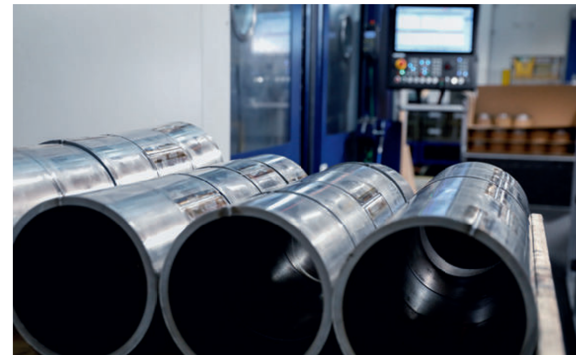
Die Gleitlagerbuchsen werden aus einem Verbundmaterial gefertigt und kommen in Anwendungsbereichen bei Durchmessern von 125 bis 500 mm zum Einsatz.
