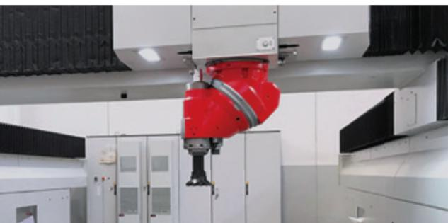
Die Struktur des im Querbalken der Maschine integrierten Z-Schlittens garantiert maximale Steifigkeit und absolute Dynamik.
