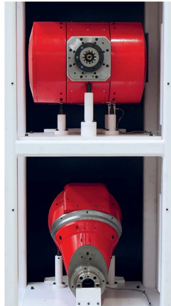
Vollautomatisches Kopfwechselsystem zur Speicherung von bis zu 4 Köpfen
