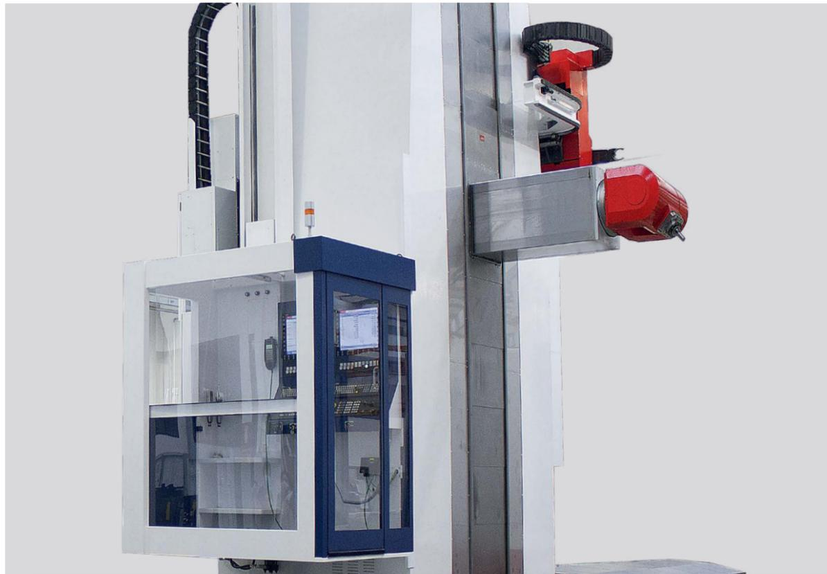
POMO- und POVT-Arbeitsbühne mit Vertikal- (bis 2500 mm) und Querfahrwerk (bis 800 mm).
