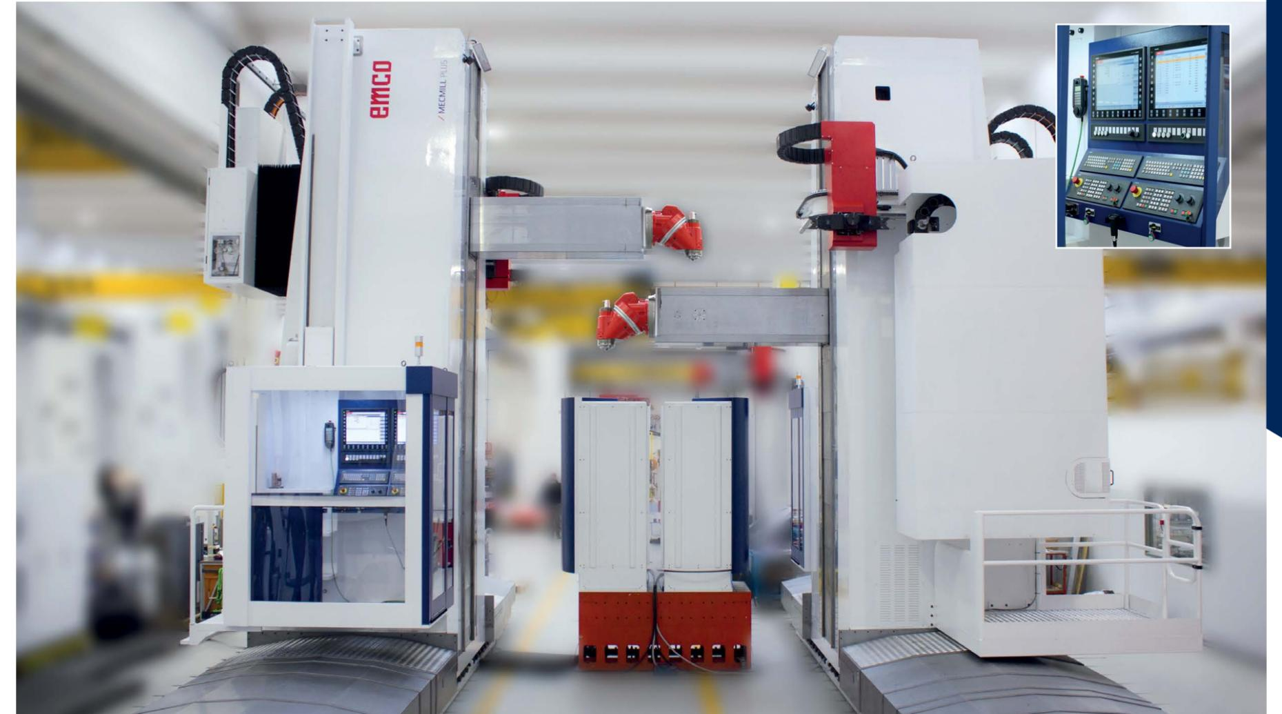
Beispiel einer Doppelständermaschine mit Wechselkopfmagazin und möglicher Pendelbearbeitung. Die Maschinen sind auf Master Slave-Betrieb ausgelegt und mit einer Antikollisionssoftware ausgestattet.
