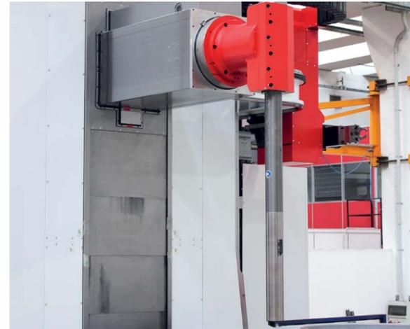
Drehstahlhalter in Wechselkopf-Ausführung zur Aufnahme von Bohrstangen bis zu 1500 mm
