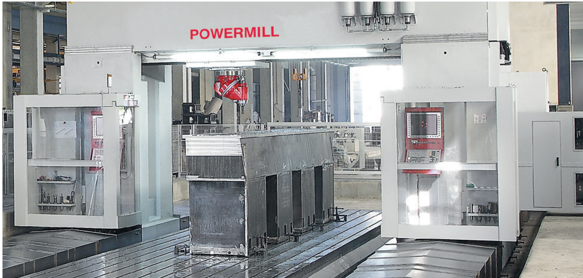
Fräsvorgang an einer Strukturkomponente von Werkzeugmaschinen
