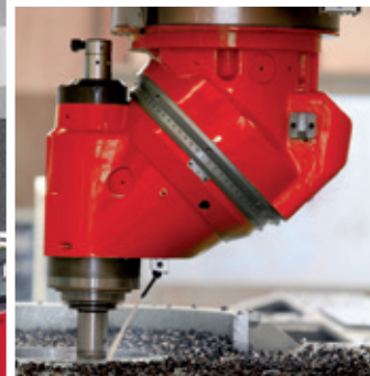
Kontinuierlicher 5-Achsen Universalfräskopf
