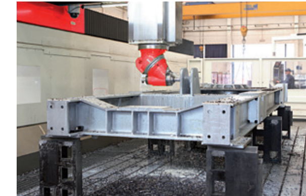
Fertigung eines Rahmens für ein CNC-Holzbearbeitungszentrum
