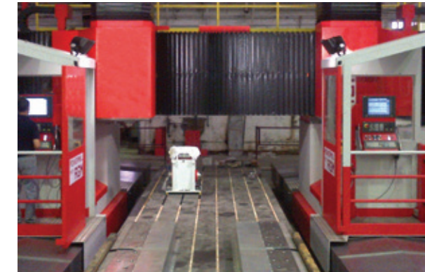
Powermill in der RGM-Ausstattung, für Schwerzerspannung in der Schienenbearbeitung bestimmt
