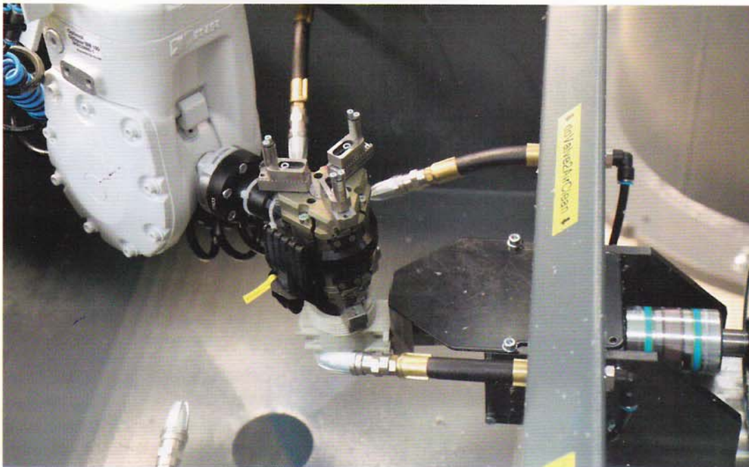
Reduktion der Nacharbeit: Sowohl eine Entgratstation als auch die Abblaseeinheit sorgen für eine erhöhte Wirtschaftlichkeit der Zelle.
